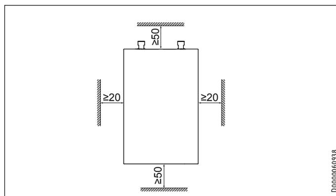
► Respectez les distances minimales de sorte à assurer un fonctionnement sans incident et à faciliter les travaux de maintenance.
